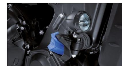
Nos phares auxiliaires Beam et Beam 2.0 peuvent être montés sur les patins de protection moteur R19.
