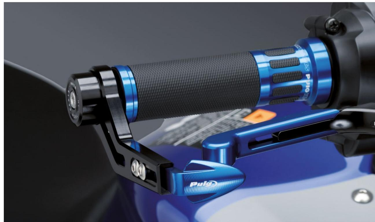
La protection du levier de frein découle de la nécessité d'éviter tout contact accidentel avec d'autres pilotes. Dans la conception, Puig a donné la priorité à la protection et à l'intégration de la pièce dans son ensemble. Pour cela, un système de réglage bidirectionnel a été conçu (longitudinal et perpendiculaire à la poignée).
