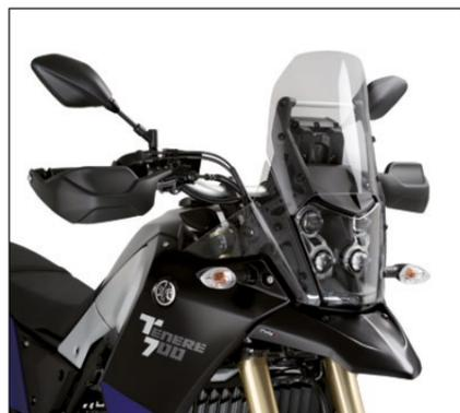
Cette extension en forme de bec protège contre les éclaboussures et les impacts de petits objets tels que les pierres et les insectes, aussi bien sur route que sur chemins de terre.
