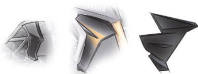
Recouvrent les parties latérales du radiateur et créent un flux d'air continu améliorant la protection du conducteur au niveau des jambes.
