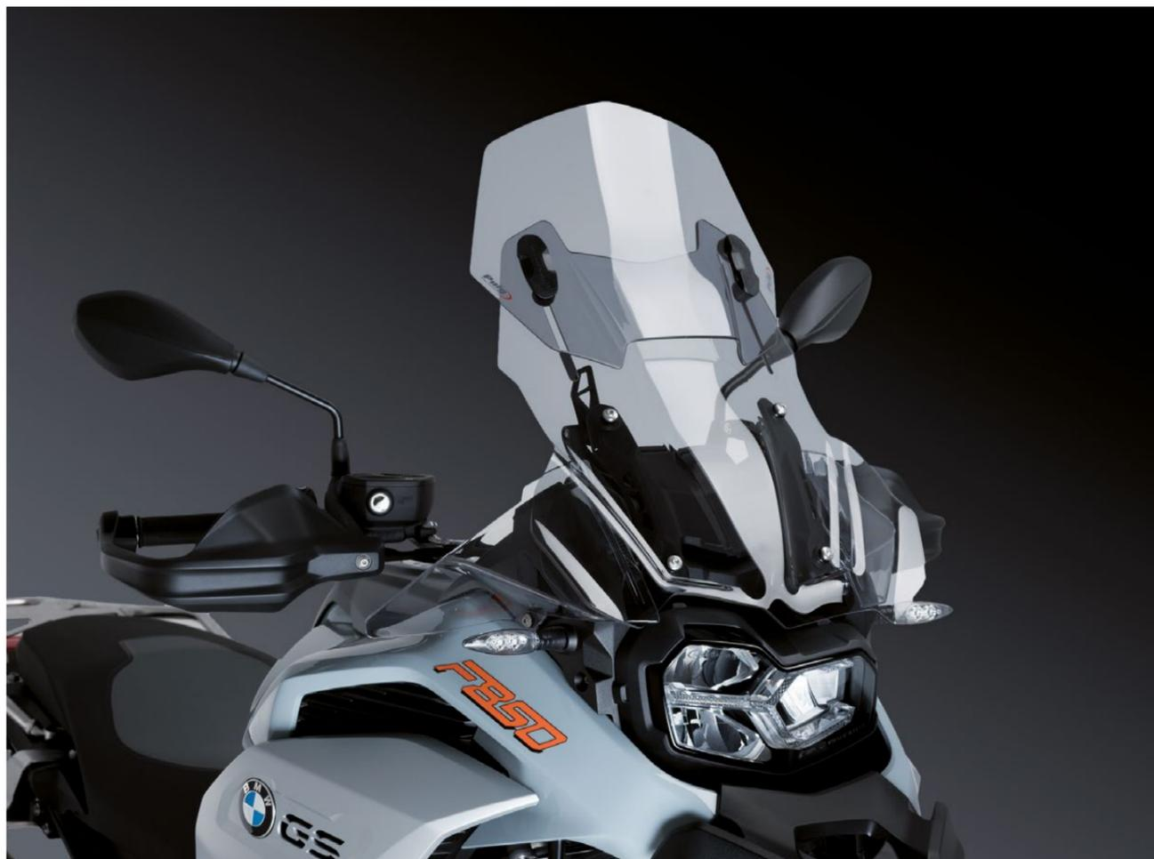
Grâce à l'incorporation d'un mécanisme réglable, la hauteur de l'écran peut être relevée rapidement et facilement, s'adaptant immédiatement aux besoins de chaque situation et type de parcours, Offroad, ville, autoroute...
