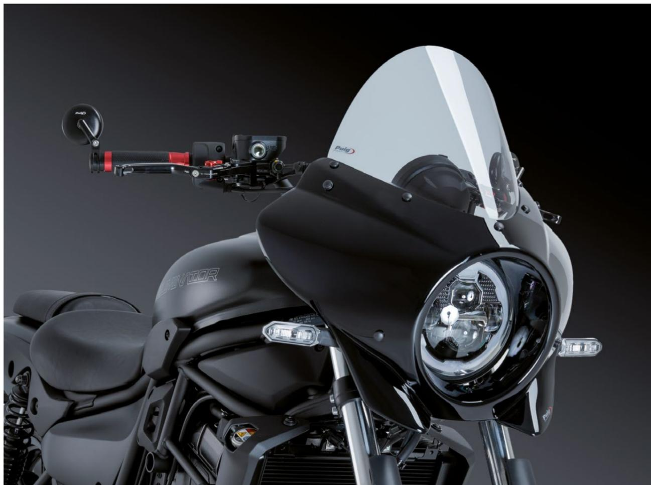
Le semi-carénage Mirage se compose d'un carter en plastique noir disponible en différentes tailles, ainsi que d'une bulle en PMMA, proposée en version transparente ou fumée. L'utilisateur peut choisir entre deux dimensions: Sport, pour ceux qui souhaitent un look plus sportif, et Touring, pour ceux qui privilégient la protection lors de la conduite.
