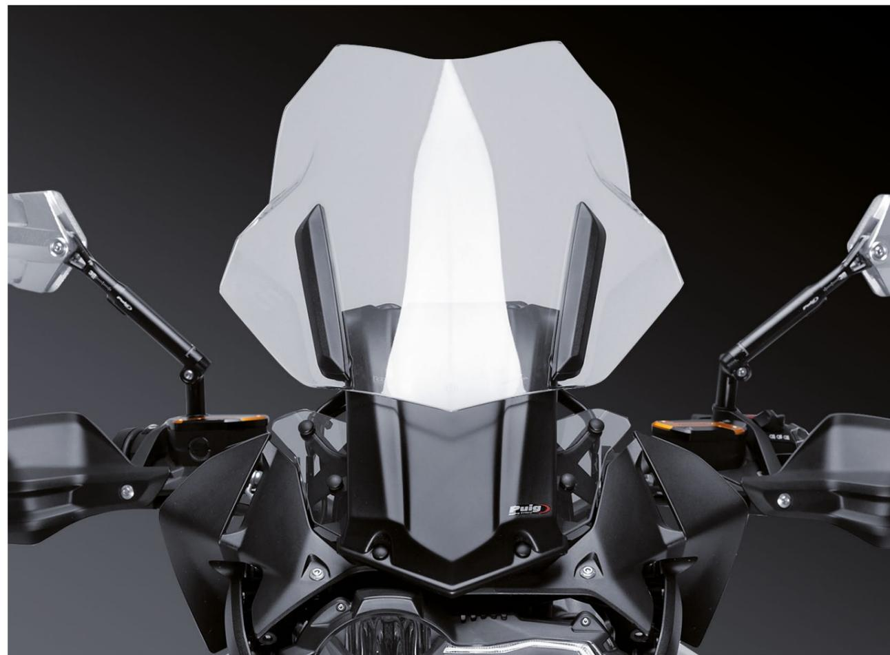
Mécanisme de réglage électrique pour votre pare-brise qui permet de le monter ou le descendre par le biais d'un simple interrupteur sans avoir besoin d'arrêter la moto.
