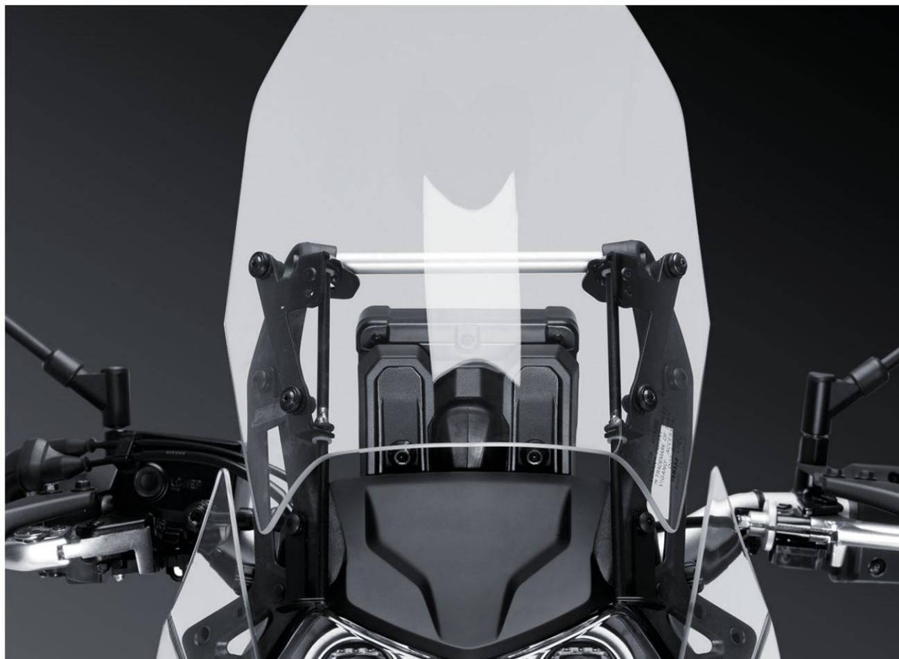
Mécanisme compact qui permet de modifier la position du pare-brise de votre moto sans outils pour s'adapter aux différentes situations de routes, en la remontant vous augmenterez la protection aérodynamique sur des voies rapides ou dans des conditions climatiques difficiles; en la rabaisant en ville ou en conduite off road pour un champ visuel plus large et sans interférences, ou tout simplement pour un look plus sportif.
