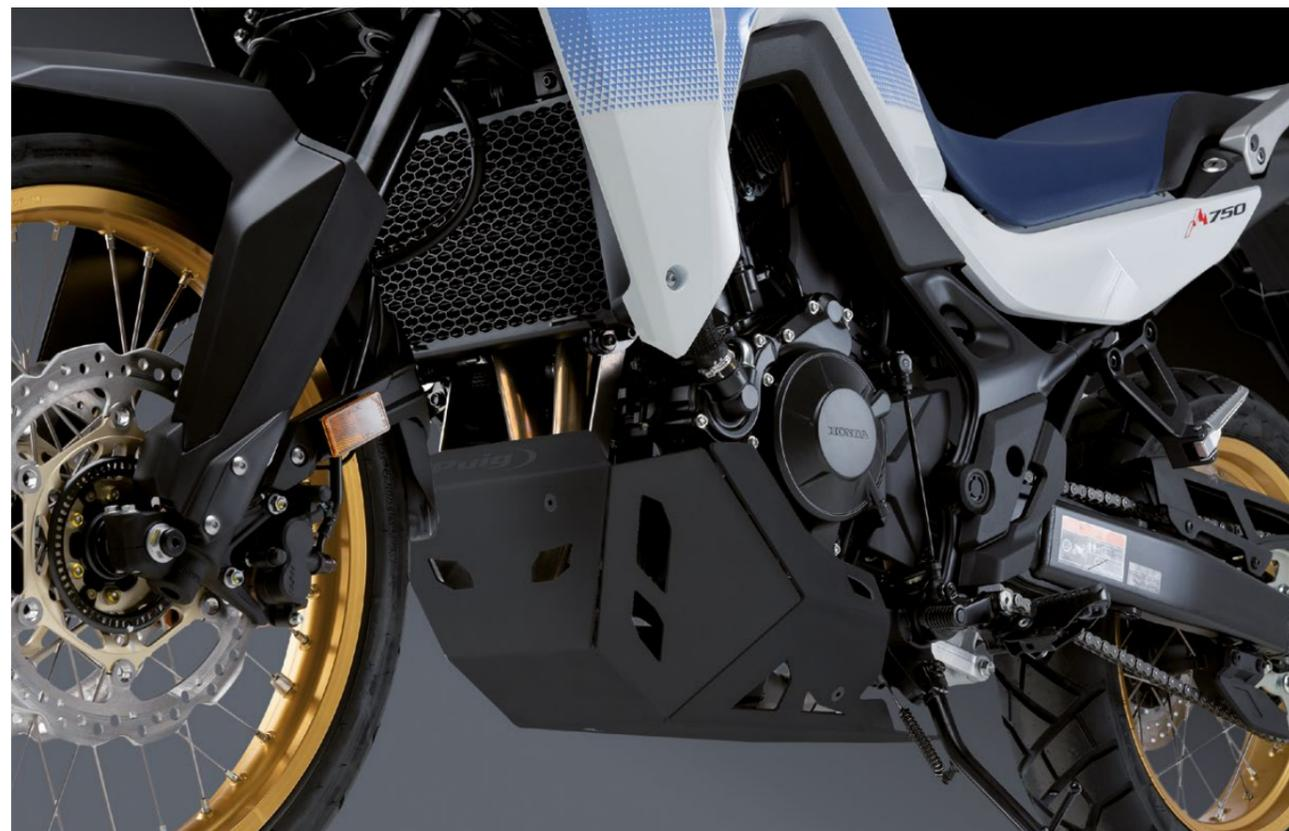
La partie inférieure de la protection est complètement plate, ce qui facilite le soulèvement de la moto de la partie inférieure dans l'atelier mécanique si nécessaire, et elle possède des trous pour garantir un bon refroidissement et évacuer l'eau, la boue ou les petites pierres accumulées.
