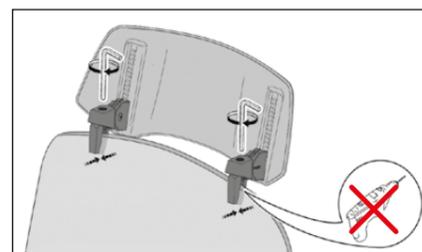
La configuration du système permet un débattement total de 65 mm, réparti entre deux positions principales : la position haute et la position basse. Ces positions garantissent un réglage précis et polyvalent, adapté aux besoins spécifiques de l'utilisateur.
