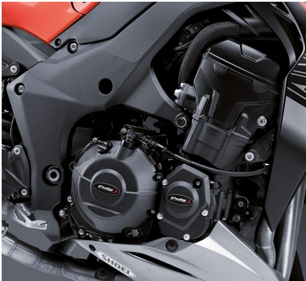
Fabriqué en polypropylène de 4 mm pour plus de protection, de résistance et de longévité tout en améliorant l'esthétique. La protection vient simplement se visser sur la pièce d'origine du moteur.
