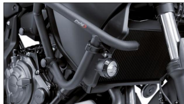
Nos feux auxiliaires BEAM / BEAM2.0 / BEAM 3.0 peuvent être montés sur nos protections tubulaires.
