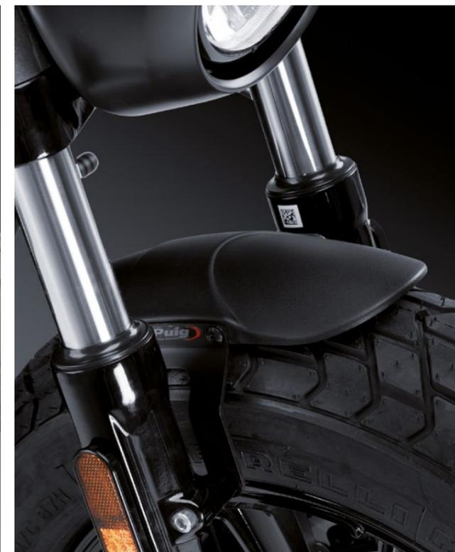
Il conserve les points d'ancrage d'origine, le rendant facilement interchangeable avec l'original et s'adapte parfaitement aux points de fixation du véhicule.
