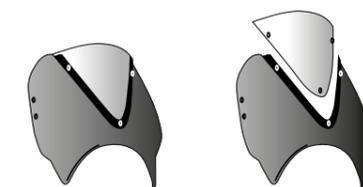
Les saut de vent Retrovison se compose d'un carénage opaque (noir ou apparence carbone) et d'une petite bulle (fumée claire, foncée, noire ou incolore).
