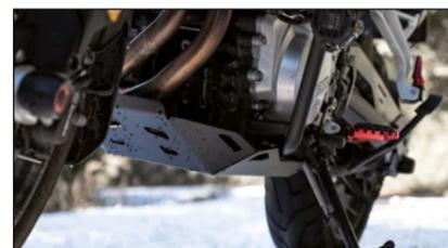
Avec son installation, les zones sensibles sont protégées contre les dommages et les impacts des pierres et de la boue, comme le carter et les collecteurs, encore plus important si l'on tient compte des possibilités Offroad offertes par les deux modèles.
