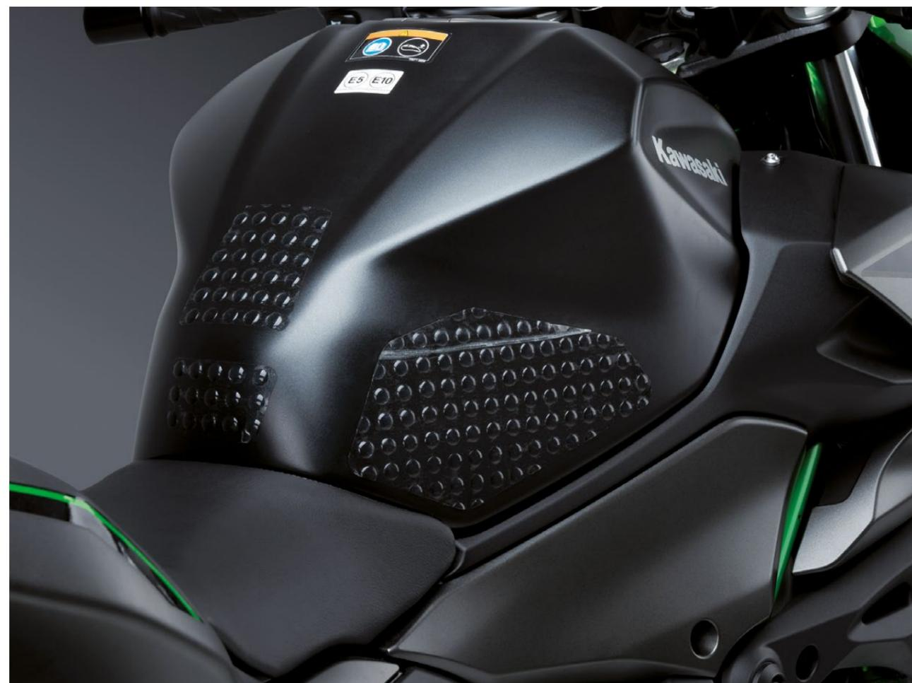
La protection de réservoir Grip de Puig se distingue par sa grande transparence, préservant l'esthétique de la moto. Fabriquée en polyuréthane, elle est ultra-fine, avec uniquement les "dimples" visibles pour améliorer l'adhérence, tandis que le reste du matériau est presque imperceptible.
